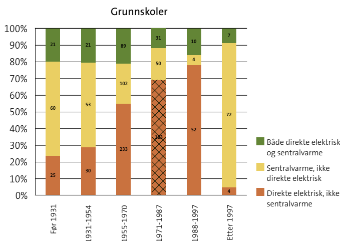
Figur 4.8: Typer oppvarmingsanlegg installert i 332 grunnskolebygninger i de ulike aldersgruppene. Andelene er prosent av samlet oppvarmet areal innen hver gruppe. Tall i søylene er oppvarmet areal i 1.000 m 2 .
