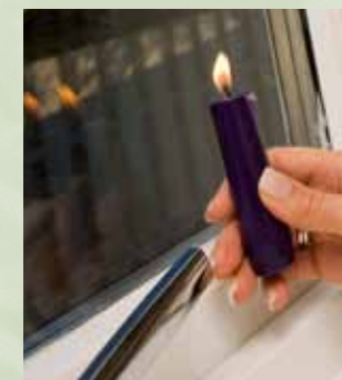
Test om du har du lavenergivinduer: Hold en flamme skrått mot vinduet - dersom en av flammene har en annen farge enn de øvrige, er det sannsynlig at du har et energiglass.
