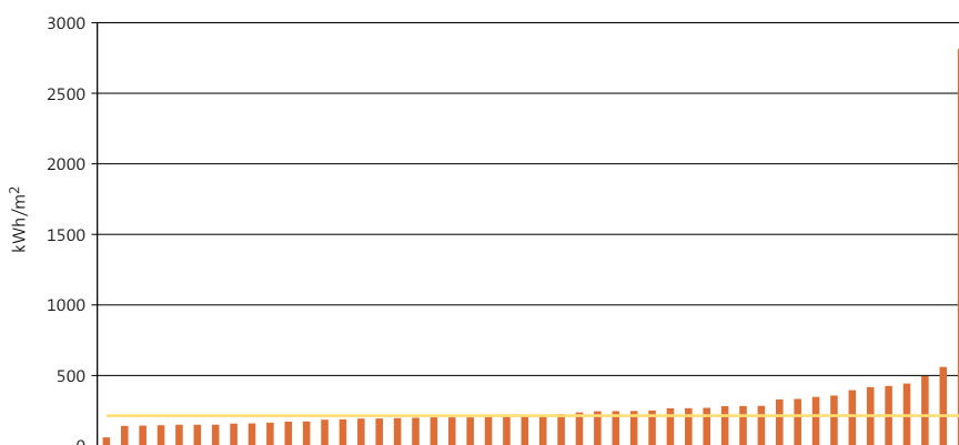
Figur 5.13: Temperatur- og stedskorrigert spesifikk tilført energibruk i kWh/m 2 oppvarmet areal for de enkelte universitets- og høyskolebygningene (kode 62) i 2009. Antall bygg: 48. Medianen er 216 kWh/m 2 .
